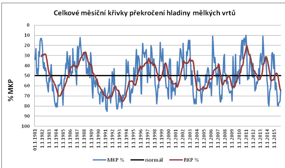
Obr. 8 Normalizované odchylky (zařazení měsíční křivky překročení – MKP) hladiny mělkých vrtů za období 1981–2015 s ročním klouzavým průměrem (RKP), zdroj: ČHMÚ
